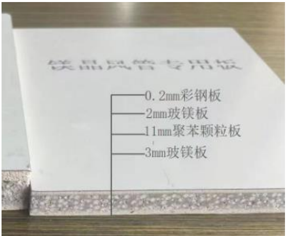
彩钢板+双层玻镁板+聚苯颗粒板：16mm（合规）
